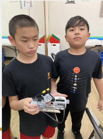
今天的乐高机器人课，同学们分组做机关枪 (Machine Gun)，从结构的组成（枪身、弹匣、枪管、脚架）到结合齿轮跟动力装置，同学们各自执掌不同部件，再组装成型，最后做测试。机枪的结构部分还是比较难的，编程部分相对的比较简单，只用到touch sensor做板机（按下后开始运作）跟motor做射击的动作，弹匣跟枪管的部分可以再改进，让子弹不会乱跑。
